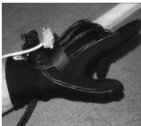
لوحة (٤) : قفازات اللمس (tactile Glove)
