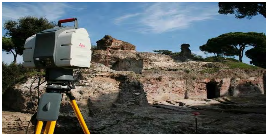
لوحة (١٠): عملية المسح باستخدام تقنية الليزر الثلاثي الأبعاد لأطلال ميناء بورتوس في إيطاليا
