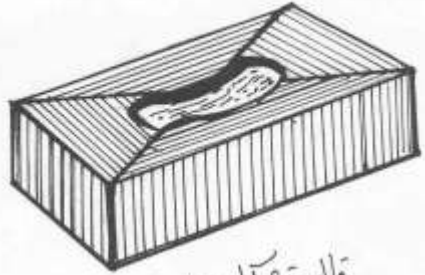
قالب تشكيل حراري مفتوح وفيه انبساط خليطة الزجاج
