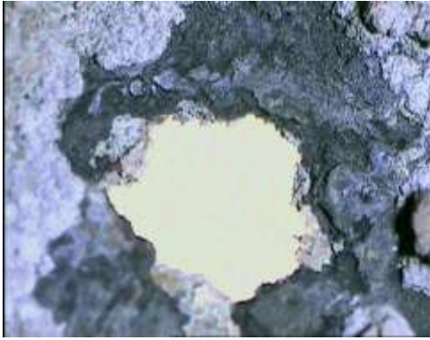
صورة رقم (11): صورة ميكروسكوبية بقوة تكبير 25X لطبقات الصدأ والتآكل بغطاء الإناء. صورة رقم (12): جزء مفقود بغطاء الإناء ومدى ما بالإناء من تآكل، قوة تكبير 25X.
