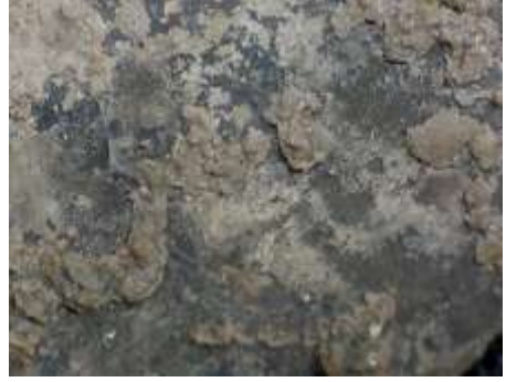
الصورتان رقمي (15،16) توضحا نواتج الصدا الرمادية إلى السوداء التي تغطي سطح الإناء، بقوة تكبير X25.
