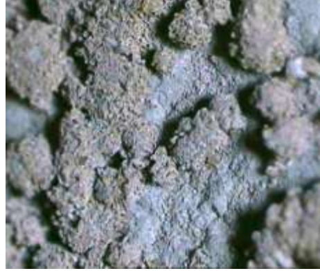
صورة رقم (11): صورة ميكروسكوبية بقوة تكبير 25X لطبقات الصدأ والتآكل بغطاء الإناء. صورة رقم (12): جزء مفقود بغطاء الإناء ومدى ما بالإناء من تآكل، قوة تكبير 25X.
